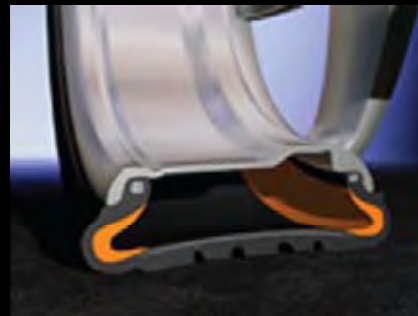
Llanta SSR después de perder aire: La llanta puede manejarse a una velocidad de 80 Km/hora a una distancia máxima de 80 Kms.
